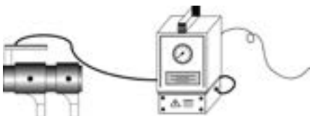
Hydraulické náradie na lisovanie a rozširovanie pre Ø 125 - 160 mm vrátane nožnej pumpy (základné náradie)
